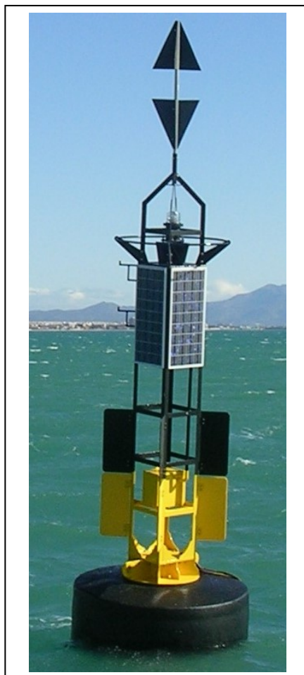
Figura 53: Boya de elastómero con equipo luminoso alimentado por energía solar
