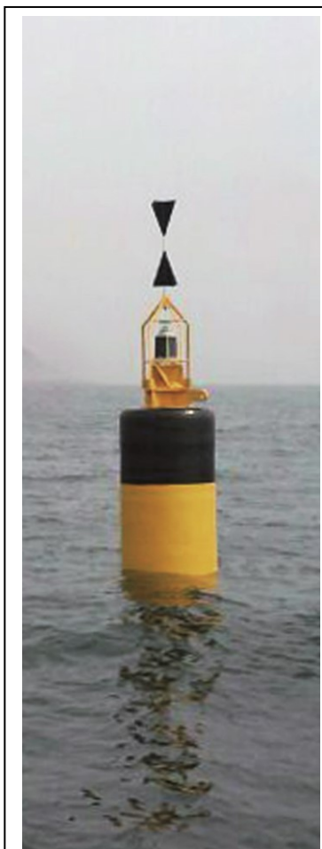
Figura 52: Boya de elastómero con linterna compacta
