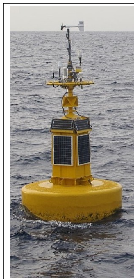
Figura 54: Boya de elastómero con equipos de medición alimentada por energía solar y eólica
