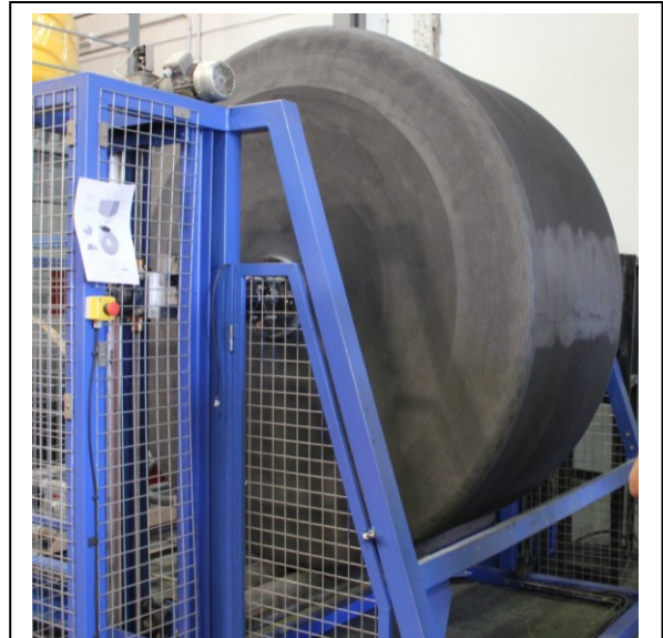
Figura 46: Polietileno de célula cerrada ligado tras el calentamiento
