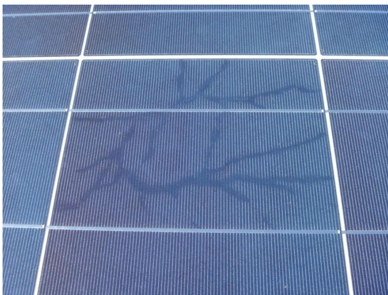
Figure 28 Exemple de traces d'escargots sur un module solaire (issu d'Internet).
