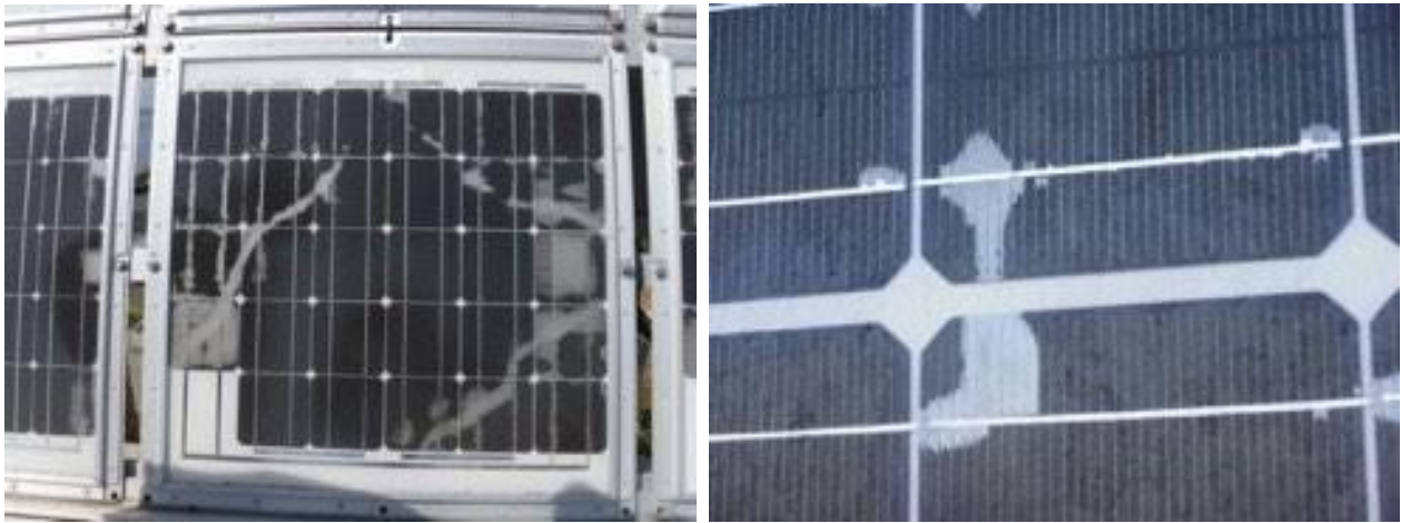
Figure 32 Exemples de délamination
