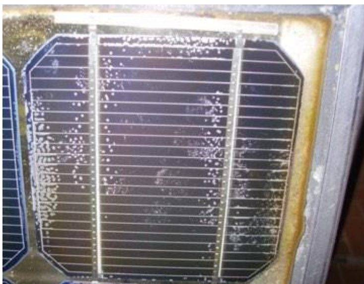
Figure 31 Corrosion d'une cellule
