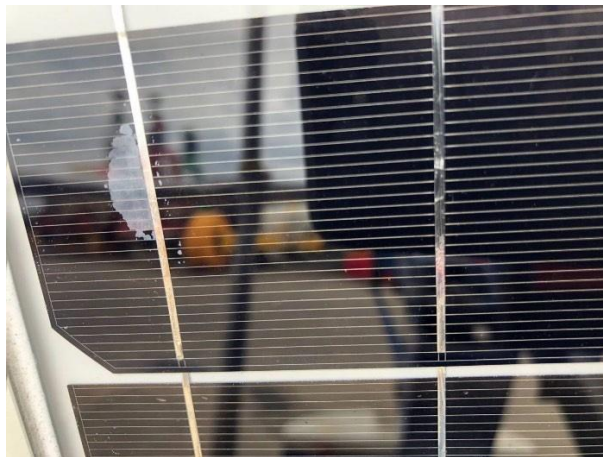
Figure 39 Délamination sur un module solaire neuf
