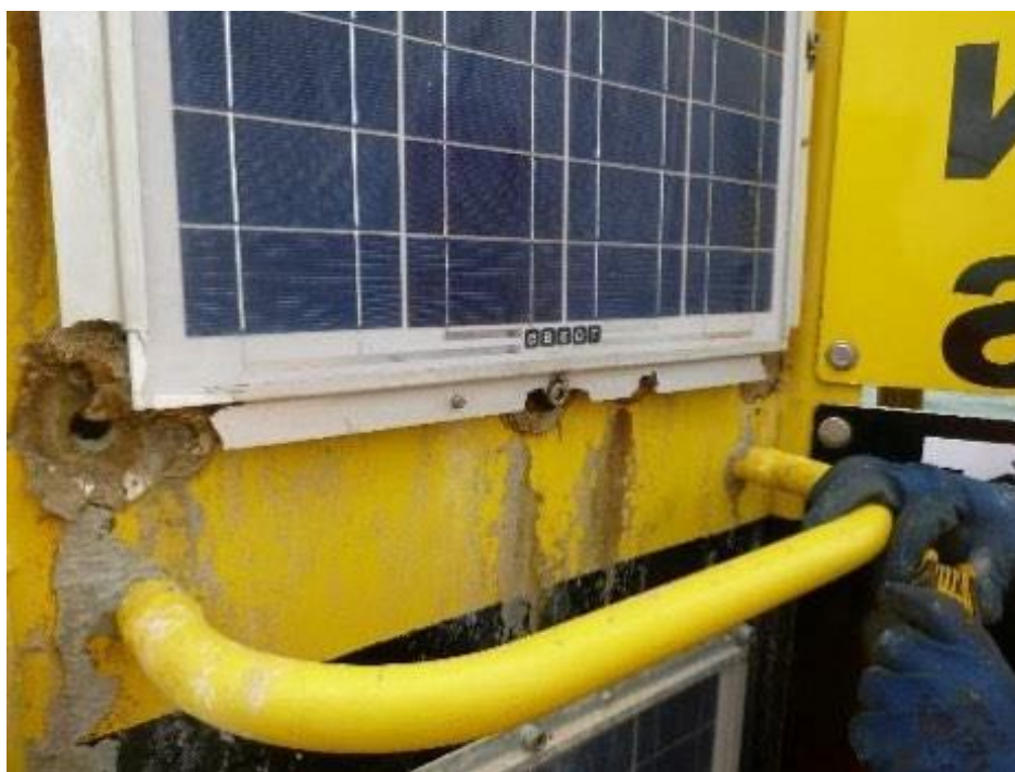
Figure 36 Impact d'un courant de fuite
