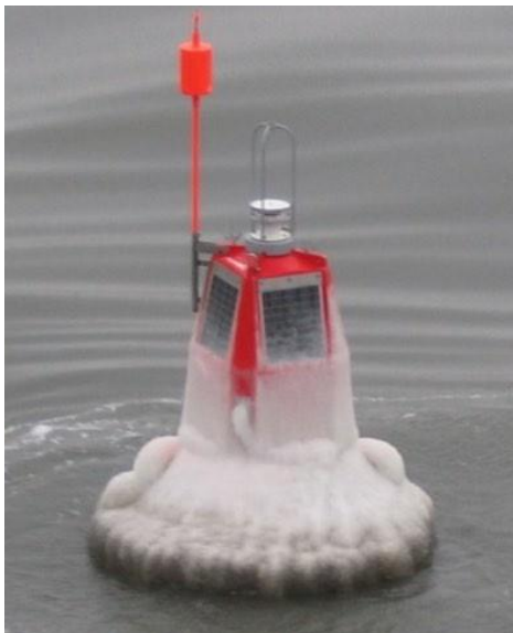
Figure 41 Exemple d'accumulation de glace sur une bouée.
