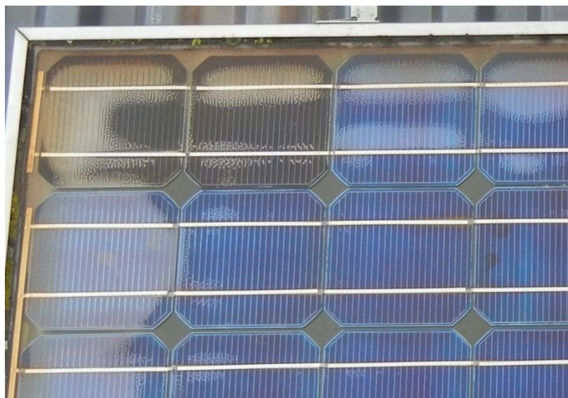
Figure 35 Décoloration de l'encapsulant
