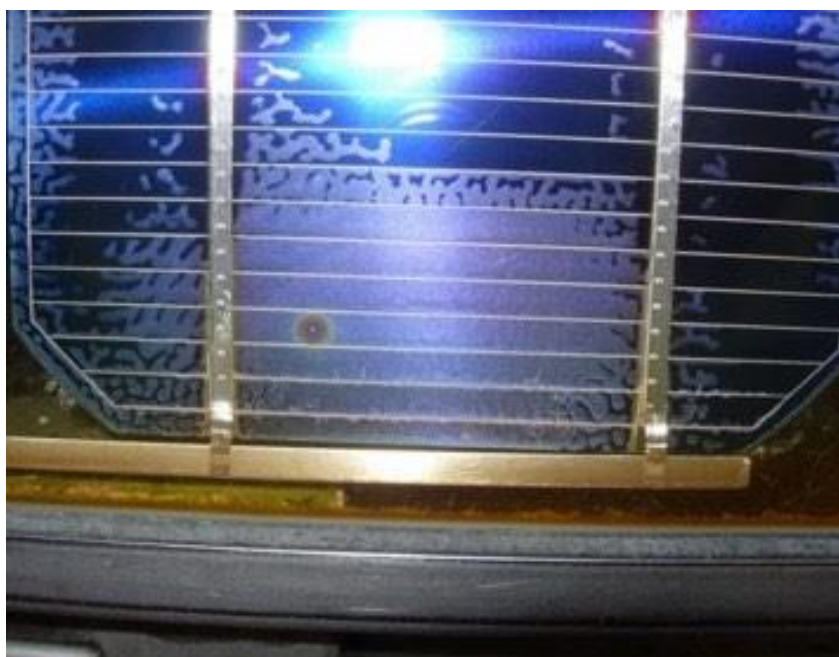
Figure 29 Exemple de point chaud dans un module.
